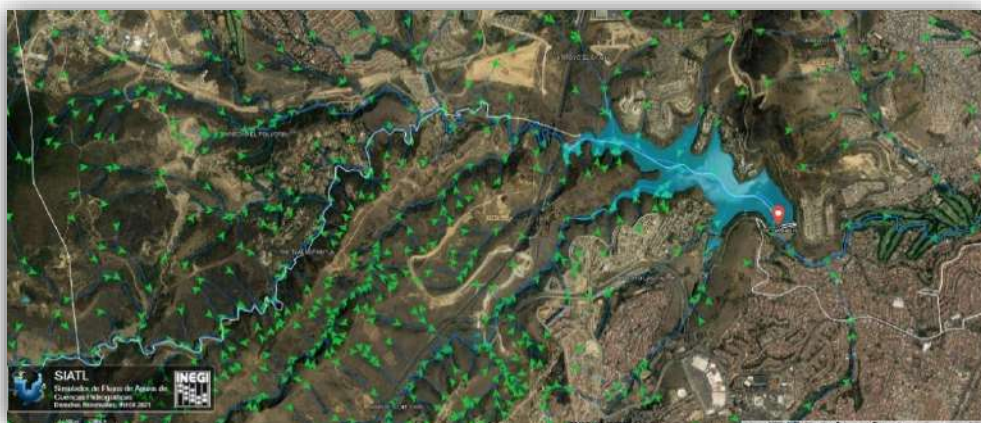
Figura 5. Dirección de flujo de las corrientes hidrológicas hacia la Presa Madín (Imagen extraída del Simulador de Flujos de Agua de Cuencas Hidrográficas SIATL-CONAGUA) 9
